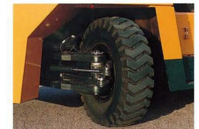
※ Full Hydraulic Power Steering (全油圧式パワーステアリング)
