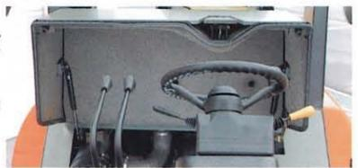
■振動伝達を抑える低振動構造。
