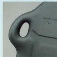
バケット形状により、万一の転倒時にもオペレーターをしっかりとホールド。バック走行時にも姿勢を安定させます。また、穴あきのため乗降時のアシストグリップとしても機能。
