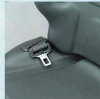
万一の転倒時にオペレーターを保護する収納式シートベルトを標準装備。乗用車で一般的なELR\*採用のため、作業時の締め付け感を低減しながら転倒時の安全性に配慮。
