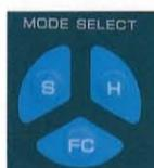
キビキビとした操作感覚のHモード、滑らかな操作感覚のSモード(初期設定)、ソフトな操作に最適なFCモード。スイッチひとつで切替られます。
